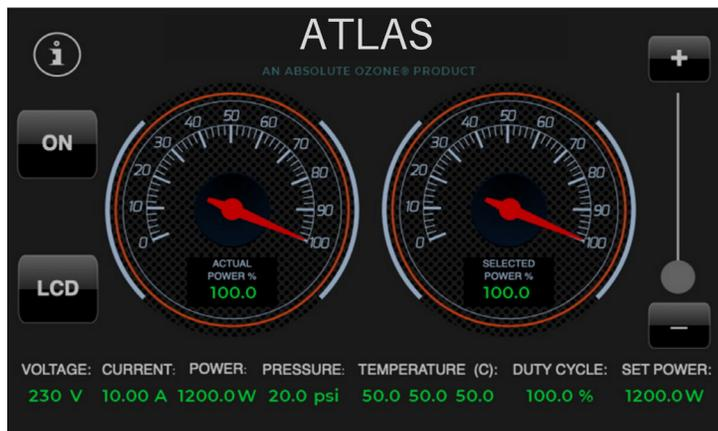
La pantalla LCD permitirá al tacto encender y apagar el generador y ajustar la potencia deseada.
